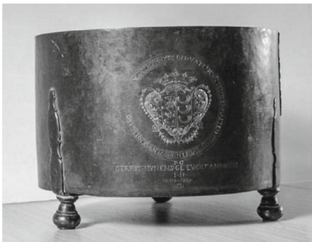
Standaardvat voor de droge inhoudsmaat behorende tot het maatstelsel gebaseerd op de lange roede van 20 voeten uit Eindhoven uit 1732. De diameter van het vat bedraagt 35,5 centimeter en de inhoud 21,5 liter. De initialen P.G. verwijzen naar zilversmid Peter Grevingh ( www.eindhoveninbeeld.com )
