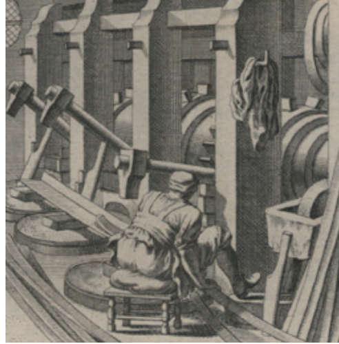
Techniek oud en nieuw: links het handwerk van de koperslager, rechts de door waterkracht aangedreven hamers. Uit: C. Weigel, Abbildung der gemein-nützlichen Haupt-Stände (Nürnberg 1698). (Publiek domein)
