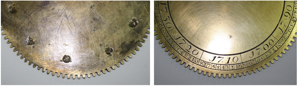
Fig. 9: De eeuwcijfers aan de achterzijde van de jaartalplaat zijn in 1711 platgeslagen om de nieuwe eeuwcijfers van de achttiende eeuw te kunnen aanbrengen (Foto's: Museum Boerhaave).
