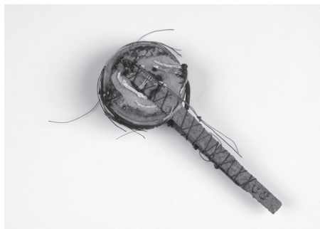
Fig. 3: Een supergeleidende spoel uit het Natuurkundig Laboratorium te Leiden. (Museum Boerhaave, Leiden)
