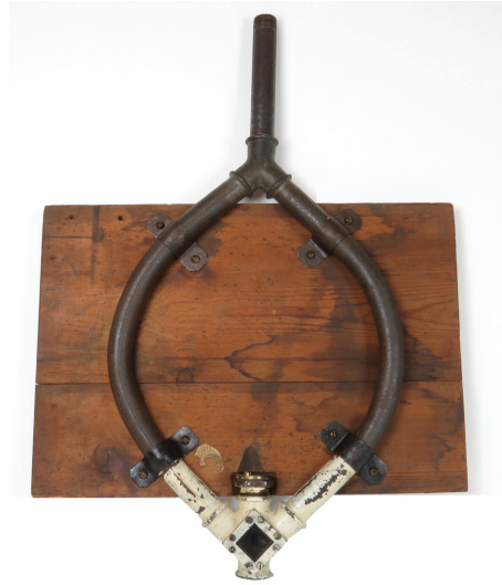
Fig. 3: Zeemans opstelling voor onderzoek naar stromingen en stroomsnelheden in de buizen, vervaardigd door de instrumentmaker Jacobus van der Zwaal. (Museum Boerhaave V21783)
