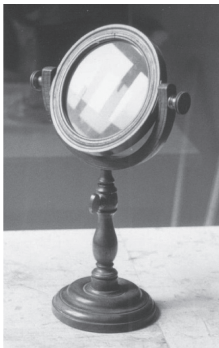
Fig. 8: Bolle lens gevat in palmhouten houder op statief. Gekocht in 1866, samen met twee andere lenzen op houten voet, voor f 27,- bij de firma P.J. Kipp te Delft. (Cat. rhbs H-4).
