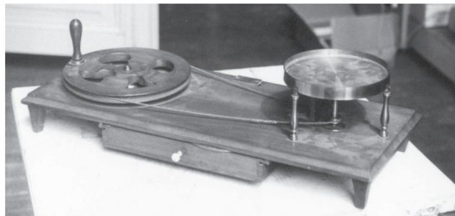
Fig. 7: Toestel naar Arago voor de demonstratie van draaistromen. In de Prijsopgave van eenige Natuurkundige Werktuigen voornamelijk ten gebruike bij het onderwijs in de natuurkunde [van de] Fabriek van Natuurkundige Werktuigen van F.W. Funckler, Hofleverancier te Haarlem (Haarlem 1867), no. 208 wordt dit instrument aangeboden voor 45 gulden.
