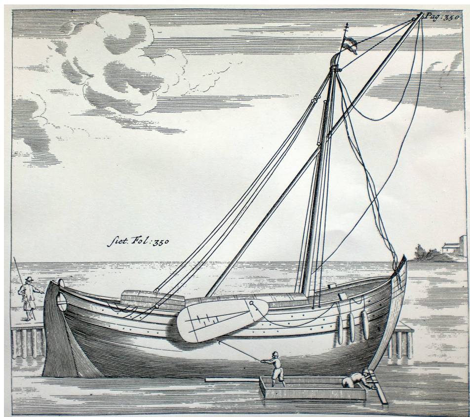
Fig. 2: Meten van de omtrek van een scheepsromp à la Hudde, uit: Cornelis van Yk, De Nederlandsche Scheeps-Bouw-Konst Open Gestelt (Amsterdam 1697), ingevoegd na p. 350.
