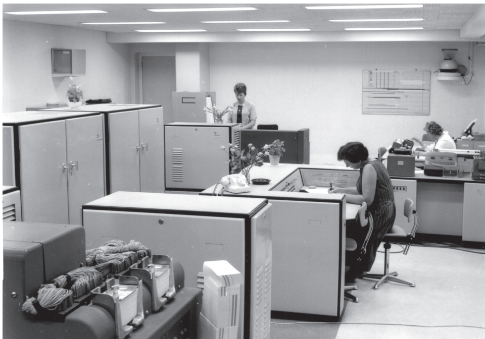
Fig. 6: Electrologica X1 in werking met ponskaartenlezer van Bull en als printer een elektrische typemachine van IBM. Foto Archief CWI.
