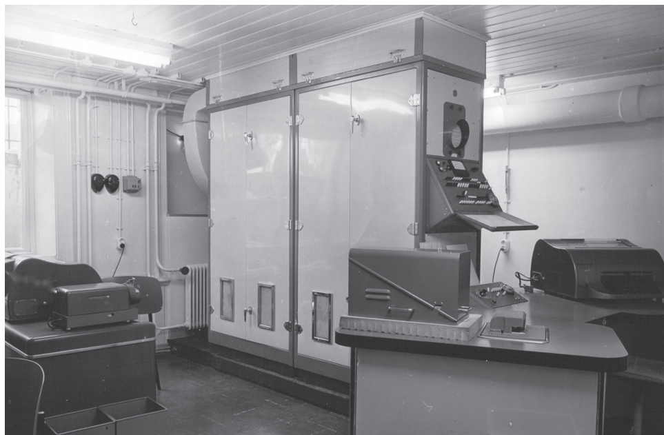
Fig. 1: De Zebra—het Zeer Eenvoudig Binair RekenApparaat—in het souterrain van het Mathematisch Instituut aan de Reitdiepskade; links de teleprinter en rechts de bedieningsconsole. (Foto: CIT)
